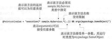
图 11-6 args 切入点指示符指定传递给目标方法的对象实例
